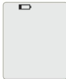
Une fois que l'icône de pile est affichée, le lecteur **AutoSense Voice** indique de remplacer les piles à chaque mise à l'arrêt de l'appareil.
