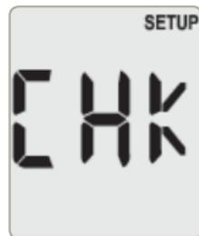
Insérez la bandelette "**Check**" incluse dans le kit **AutoSense** dans le logement pour bandelette, l'inscription "**Check**" vers le haut. Le lecteur effectue alors la mesure et affiche le résultat.
